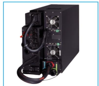
módulos externos de baterías que se pueden instalar en caliente, capaces de proporcionar alimentación a los sistemas durante horas. Los módulos adicionales de baterías son automáticamente reconocidos por el SAI.
