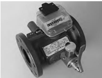
Existen dos versiones de turbinas; libres de mantenimiento, estos equipos cuentan con rodamientos auto-lubricados, o equipos con lubricación externa, mediante bomba inyectora de aceite (detalle en fotografía) . La lubricación se debe realizar cada 2(dos) o 3(tres) meses en condiciones de gas normal, o mas seguido en caso de gases mas contaminados.
